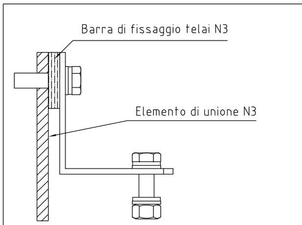
Esempio di ancoraggio sotto struttura di un telaio N63B:
