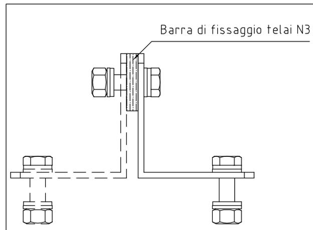
Esempio di ancoraggio sotto struttura di due telai N63B:
